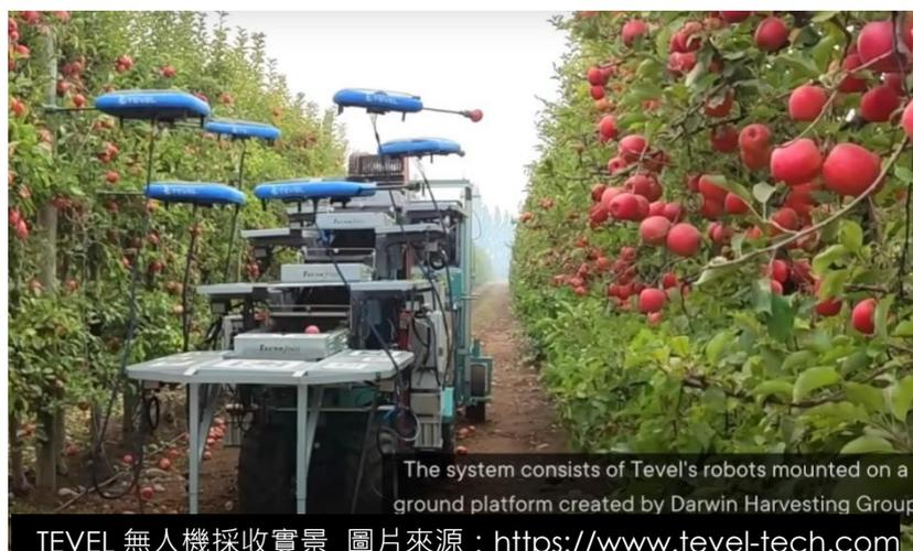
Tevel Tech 的專利涵蓋飛行器、果實辨識、摘取裝置，及集果車間的虛擬連結等技術，重點布局了澳洲和巴西，其中 US11709493B2 飛行器架構與 EP4329470A1 摘取裝置兩項專利(如下方圖)，揭示了無人機搭載細節：多重感測器(距離/壓力感測器)，及結合兩顆鏡頭；在摘取裝置的部分則使用了真空吸附技術，與可拉伸扭轉的接頭共同運作。
