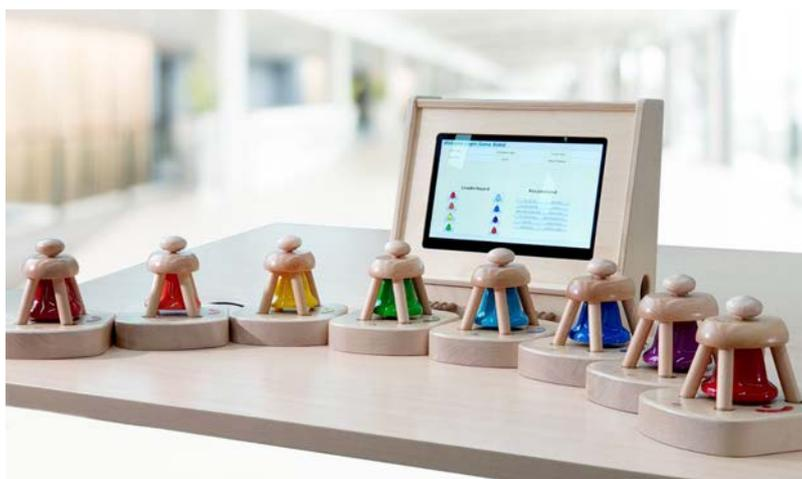
在傳統樂器的按壓音階加上壓力感測器，連接至「音樂同步互動訓練系統」，可紀錄使用者的按壓次數、節奏感、拍打力度等資訊。
